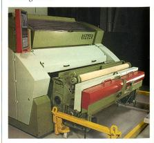
Abb. 1: Die neue Hochleistungskarde C 60
