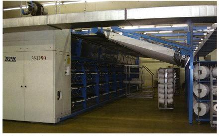
Modernster Maschinenpark – unser Bild eine Texturiermaschine von RPR (I)
