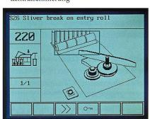
Abb. 8: Bebilderte Fehleranzeige am Display
