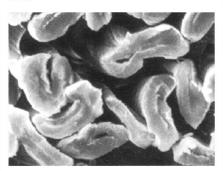
Abb. 1: Querschnitt durch einen Baumwollfaden
