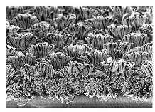
Abb. 7: Dichtes Gewebe für OP-Kleidung «Microtec», Lauffenmühle (D)
