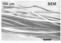
Abb. 3: An der EMPA mit Silber beschichtetes Polyesterfilament
