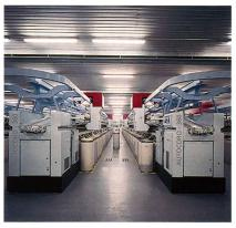
Abb. 3: FANCYNATION – zur Herstellung von Effektgarnen
