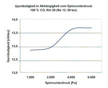
Abb. 2: Garnfestigkeit in Abbängigkeit vom Spinnunterdruck
