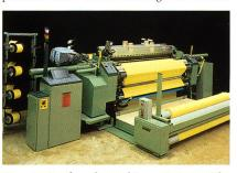
Dornier-Greiferwebmaschine mit einem Filtergewebe aus Monofilament und integrierter Warenschau
