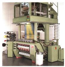
Moderne Luftdüsen-Webmaschine in SILENT-Ausführung für die Schalproduktion
