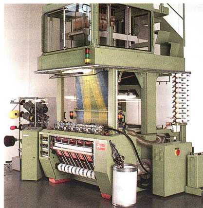
Moderne Luftdüsen-Webmaschine in SILENT-Ausführung für die Schalproduktion
