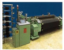
Dornier-Luftdüsenwebmaschine AWS 6/S mit einem schusselastischen Wollgewebe
