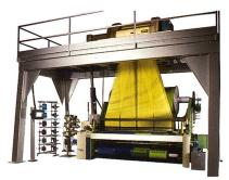
Terryplus-6-J 260 von Picanol – Florbildung durch servomotorgesteuertes Schwenkladensystem
