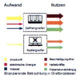
Bilanzierende Betrachtung in Greifprozessen ten führen würden. Weitere Vorteile des patentierten Gefriergreifers CRYOP sind:
