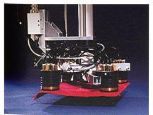
Gefriergreifer mit 4 Greifelementen NAISS CRYOP 50 (Quelle Internet)
