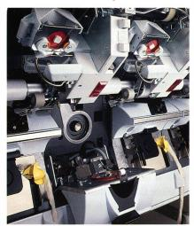
Abb. 4: Individuell angetriebener Faserbandeinlauf und Magnetlager an der Corobox SE 12
