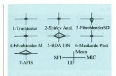
Abb. 1: Strahlenförmige Graphen der HVI-Parameterdifferenzen Mean, MIC, UI und SFI für verschiedene Laboreinrichtungen (1-4 und 6) und die Rotorspinneinheit (5)
