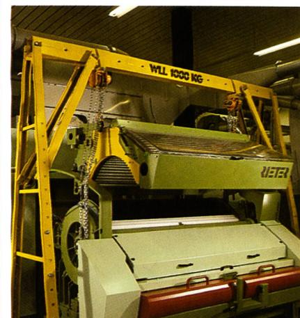
Abb. 14: Modularer Aufbau und Baugruppen der Karde C 60
