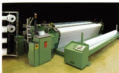
Luftdüsenwebmaschine ATVF 8/J für Frot-tier, Typ ServoTerry®
