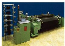
Dornier-Luftdüsenwebmaschine AWS 6/S mit einem schusselastischen Wollgewebe
