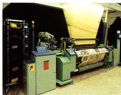
Greiferwebmaschine PTS 12/J für 12 Farben und Jacquardmaschine Stäubli LX 3201 mit 10'752 Platinen
