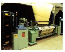
Greiferwebmaschine PTS 12/J für 12 Farben und Jacquardmaschine Stäubli LX 3201 mit 10'752 Platinen
