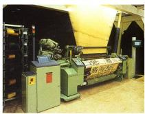
Luftdüsenwebmaschine AWSL 4 mit selbstangetriebener, oberbauloser Drehereinrichtung EasyLeno®
