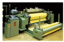
Greiferwebmaschine PTS 4/S mit beidseitigem MotoLeno<sup>®</sup>, AirGuide<sup>®</sup> Greiferstangenfübrung und integrierter Warenschau LOOM-TEX von EVS, Israel, mit einem Filtergewebe aus Monofilament
