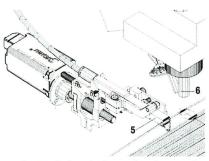
Aus der Kettfadenschicht werden die einzelnen Garne mittels einer Saugdüse (5) abgetrennt und vereinzelt. Dabei prüft das optische System (6) (Kamera mit Bildverarbeitung), ob es sich um den richtigen, einzelnen Faden bandelt.
