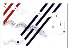
Während des Einlesevorgangs werden gleichzeitig 2 Fadenkreuze in die Kette eingelesen. Die einzuziehenden Kreuzfäden bängen an den so genannten «Shuttles» (7), welche abwechslungsweise nach oben und unten bewegt werden.
