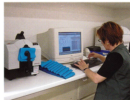
Sämtliche Gewebe werden auf Nuancenkonformität und -homogenität geprüft.
