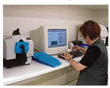
Sämtliche Gewebe werden auf Nuancenkonformität und -homogenität geprüft.
