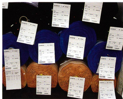
Fehler-Mass-Protokoll: Der Konfektionär erhält Aufschluss über Art und Position vorhandener Fehler.
