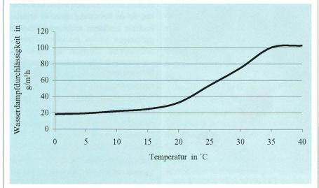
Abb. 2: Temperaturabhängige Wasserdampfdurchlässigkeit eines Shape Memory Polymers
