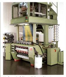
Moderne Luftdüsen-Webmaschine in SILENT-Ausführung für die Schalproduktion
