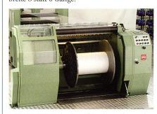
MW1000U Zettelanlage für elastische und nicht-elastische Garne für Kettbäume bis 1'000 mm
