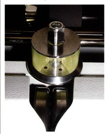
CompactTwister – magnetgestützte Paraffinierung
