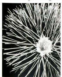
Querschnitt durch Flockgarn unter dem Mikroskop
