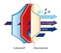
Abb. 4: Windstopper® Soft Shell Laminat
