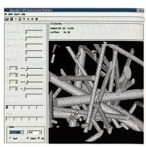
Abb. 2: Dreidimensionale Ansicht eines Stapelfaservliesstoffes aus drei Faserkomponenten
