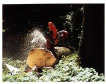
Sicherheit bei der Forstarbeit: Schnittschutzhosen schützen den Träger, wenn einmal die Kettensäge aufs Bein rutscht. Eine Spezialeinlage blockiert die Säge innert Sekundenbruchteilen.
