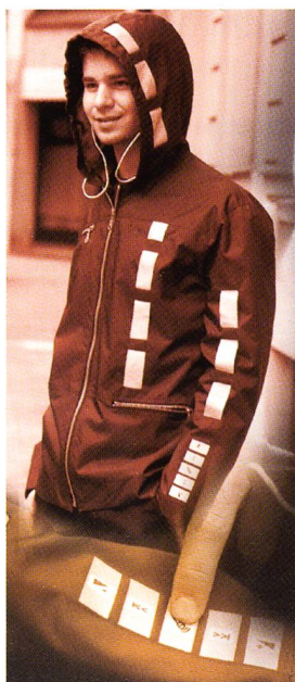
Infineon-Anorak mit Textildraht (Datenübertragung)
