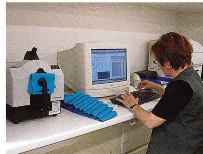
*Sämtliche Gewebe werden auf Nuancenkonformität und -homogenität geprüft.*
