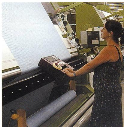
*Sichtprüfungen auf dem Kontrolltisch: Hier wird die laufende Warenbahn auf Fehler untersucht und entsprechend markiert.*
