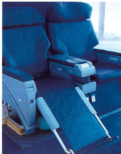
Minimales Gewicht, höchster Komfort dank Pneumatik – der Prototyp eines Zafu-Sitzes
