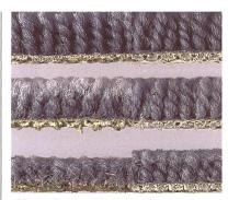
Abb. 2: Abrieb nach Trommeltest
