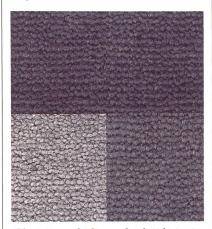
Abb. 1: Faserschädigung durch Lichteinwirkung
