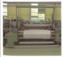
Greiferwebmaschinen können Artikel weben, die zwei Kettbäume erfordern
