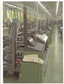
Luftdüsenwebmaschinen von Dornier (D)
