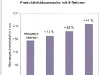
Abb. 5: Produktivitätszuwachs mit S-Rotoren
