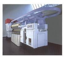
Abb. 11: Die Rotorspinnmaschine Autocoro 312 (Foto Schlafborst)
