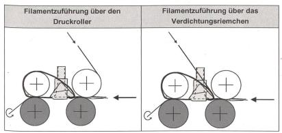
Abb. 2: Prinzipskizzen: Filamentzuführpositionen beim ITV-Verdichtungsstreckwerk
