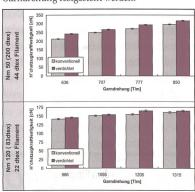
Abb. 9: Höchstzugkraftfestigkeit in Abhängigkeit der Garndrehung, Nm 50 und Nm 120
