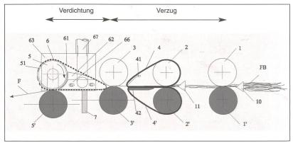
Abb. 1: 4-Zylinder-DR-Streckwerk mit perforiertem Oberriemchen (ITV-Patent DE 43 23 472)
