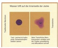
Traditionelles Laminat (links) ist bydrophob, die Schweisstropfen bzw. das Kondensat bleiben stehen. Beim TransActive Membransystem (rechts) verteilen sich die Tropfen grossflächig und können so schneller durch das Laminat diffundieren.
