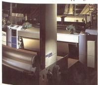
Reifenkordwebmaschine OMNIplus TC
