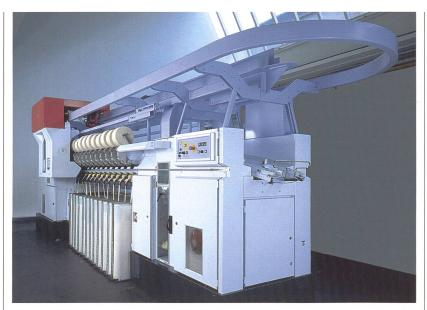
Der neue Schlafborst Autocoro 312 mit der Corobox SE 11 bietet die ideale Voraussetzung für die Herstellung von Belcoro Structured Denim
