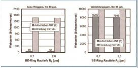
Abb. 6. Einfluss der BE-Ring-Raubigkeit auf die Scheuerfestigkeit von konventionell und verdichtet gesponnenem Garn (100% Bw gekämmt, Nm 85)
