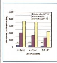
Abb. 11: Einfluss des Einlaufradius glatter Stahlabzugsdüsen (Auswahl) im Vergleich zur gekerbten Abzugsdüse S6KF auf die Scheuerfestigkeit der Garne
