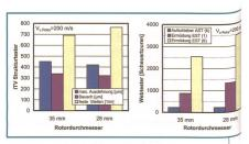
Abb. 8: Einfluss des Rotordurchmessers auf die Garnstruktur und die Scheuerfestigkeit der Garne
