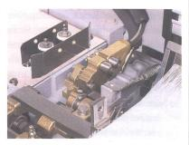
Schusseintrag an der Wasserdüsenwebmaschine Super-MAX von Textec (ROK)
