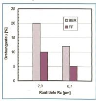
Abb. 1: Einfluss der Oberflächenrauhigkeit von BE-Ring und FF auf den Drehungsstau
