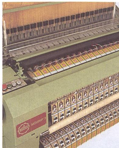
Etikettenwebmaschine MÜGRI® MBJ3.1 115
