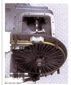
K88 – eine Greiferwebmaschine von Vamatex; Greiferantrieb
