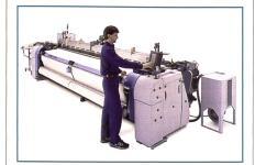
Projektilwebmaschine von Sulzer
