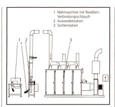
Abb. 5: Schematische Darstellung einer Recyclinganlage
