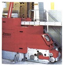
Bild 4: Elektronisch gesteuerte Rotations-Schaftmaschine 2685 an der Alpha 300
