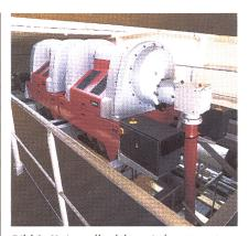
Bild 2: Universelle elektronisch gesteuerte Jacquardmaschine LX 2490 von Stäubli
