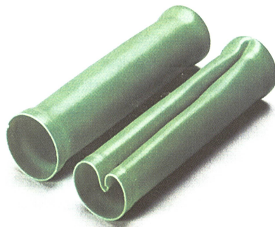
Abb. 3: Eingeknickte Hüllen beim Filamentdämpfen, links mit Contexxor®-System konditioniert
