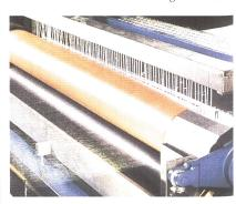
BEN-FULLSIZE - Filamentschlichtanlage mit Heisslufttrockner und Zylindertrockner
