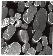
Faserquerschnitt der BASOFIL-Fasern
