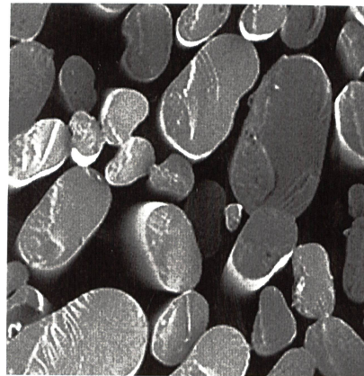
Faserquerschnitt der BASOFIL-Fasern
