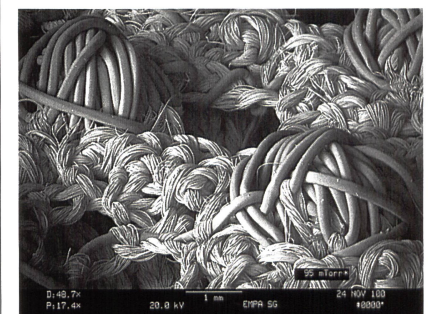
Strukturierte Oberfläche eines Wundpads (Rasterelektronenmikroskopische Aufnahme)
