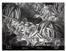
Strukturierte Oberfläche eines Wundpads (Rasterelektronenmikroskopische Aufnahme)
