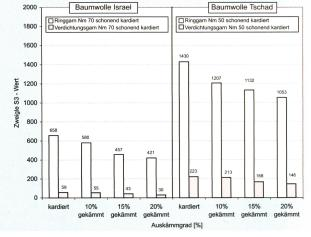
Abb. 9: Nissenzahl in Abhängigkeit des Auskämmgrades, Garntyps und Garnnummer
