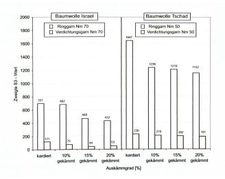
Abb. 6: Zweigle S3 - Wert in Abbängigkeit der Auskämmgrade, des Garntyps und derGarnnummer
