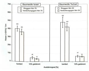
Abb. 5: Nissenzahl in Abbängigkeit der Auskämmgrade, des Garntyps und der Garnnummer
