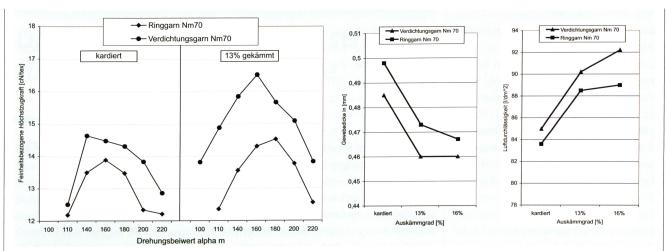
Abb. 11: Drehungskennlinien von Verdichtungs- und konventionellem Ringgarn, kardiert und gekämmt.
