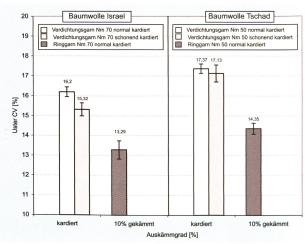
Abb. 7: Almeter Faserkennwerte der Israel Baumwolle, in Abbängigkeit der Auskämmgrade, normal und schonend kardiert
