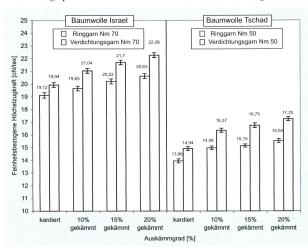
Abb. 1: Almeter Faserkennwerte der Israel- und Tschadbaumwolle in Abhängigkeit der Auskämmgrade
