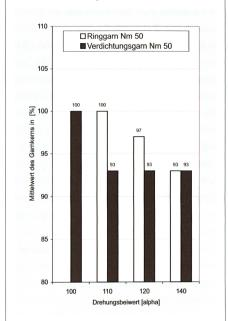
Abb. 13: Mittelwert des Garnkerns ohne abstehende Faserenden vom Ring- und vom Verdichtungsgarn Nm 50
