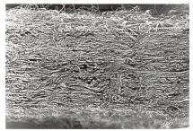
Abb. 4: Evolon Querschnitt
