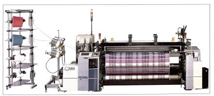
Abb. 1: Luftdüsenwebmaschine OMNIplus
