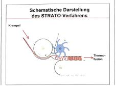
steller unter dem Namen STRATO (Papini) oder WAVEMAKER (Santex) auf dem Markt erscheint. Von der Krempel wird der Faserflor dem Senkrechtleger zugeführt. Dieser legt die aufgerichteten Faserschlaufen in den Kanal, gebildet aus dem Siebband des Durchströmtrockners (unten) und dem Leitblech des Legers (oben). Die Thermofusion folgt unmittelbar dem Legevorgang, damit die senkrechte Schichtung des Faserflors erhalten und fixiert wird.
