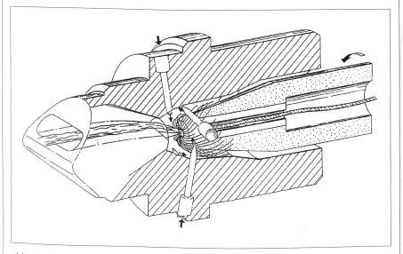
Abb 3: Schematische Darstellung der Vortex-Spinndüse
