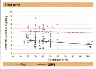
Abb 2: Die Abriebfestigkeit von COM4®-Garn ist deutlich besser als die von konventionell gesponnenem Ringgarn
