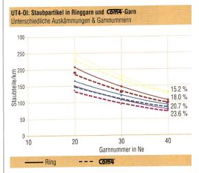
Abb 1: Geringer Staubgehalt von COM4®-Garnen
