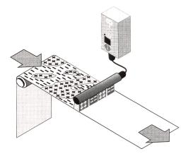
Statische Aufladungen führen in vielen Fertigungsprozessen zu Störungen. HAUG-lonisationssysteme lösen dieses Problem bei der Folien- und Papierverarbeitung sowie in der Textil- und Kunststoffindustrie.
