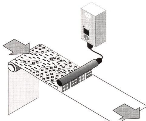
Statische Aufladungen führen in vielen Fertigungsprozessen zu Störungen. HAUG-Ionisationssysteme lösen dieses Problem bei der Folien- und Papierverarbeitung sowie in der Textil- und Kunststoffindustrie.
