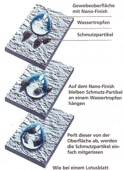
Funktionsprinzip des Nano-Finish auf Gewebe-Oberflächen
