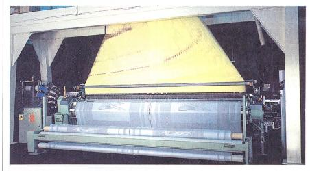
Luftdüsenwebmaschine LWV8/J mit einer Arbeitsbreite von 430 cm
